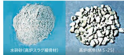
水砕砂(高炉スラグ細骨材)
